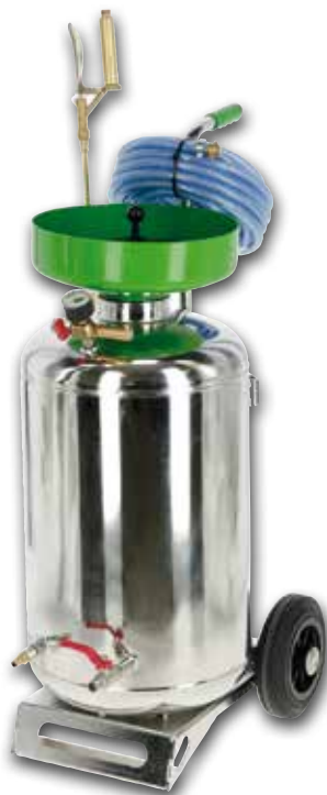
5 Universal-Weißelspritze Inox 40 Allroundspritze mit 40L Behälter aus Edelstahl, zum Weißeln mit Kalkmilch, versprühen von Desinfektionsmittel, Korrosionsschutz, zur Unkrautbekämpfung uvm. Die Spritze kann mit jedem handelsüblichen Kompressor betrieben werden. Die Lieferung erfolgt komplett mit 10m Schlauchleitung, Einfülltrichter, Spritzgarnitur inkl. Düsenatz, Lanze mit Winkel und Abstellventil sowie eine Verlängerung 750mm. Die Spritze verfügt über eine komplette Sicherheitsausstattung inkl. Sicherheitsventil, Manometer und einen Ablasshahn. Best. Nr. K 115089 EUR 698,00 Frachtpauschale: 25,00
